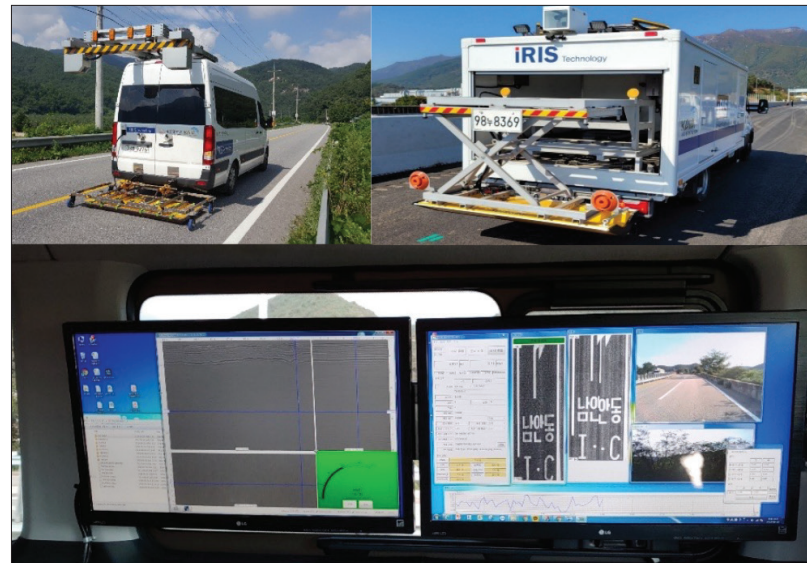
Hình 5: Hình GPR antenna được tích hợp trên xe khảo sát
